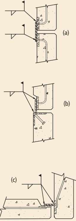
Fig. 4.5.50 Shear plate (SP6).
